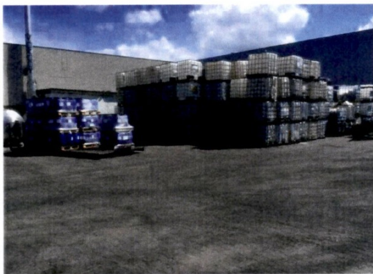
Foto 2: opslag buiten de vloeistofdichte vloer
